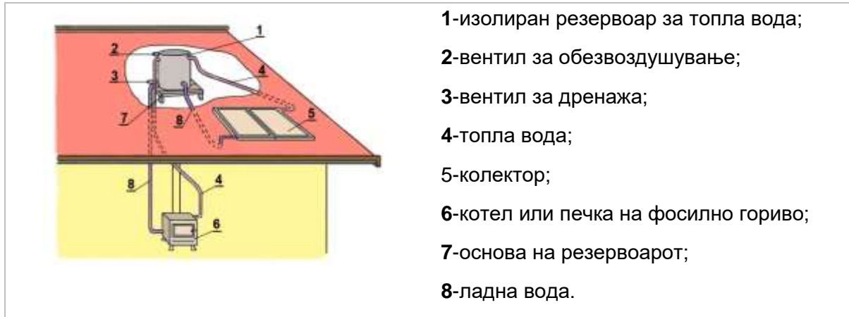
Сл.25. Термосифонска сончева постројка за топла вода со вертикално поставен резервоар сместен во таванот
