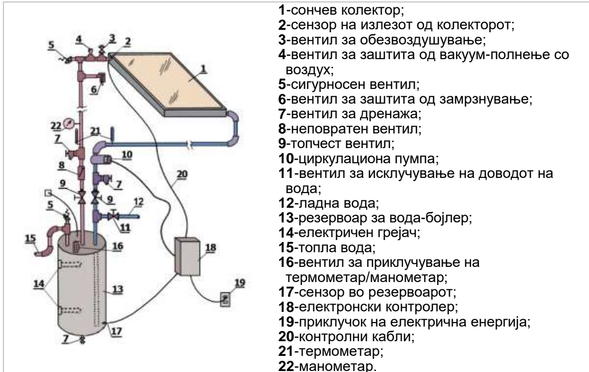
Сл.27 Директна сончева постројка за топла вода за санитарни потреби со принудна циркулација на водата
