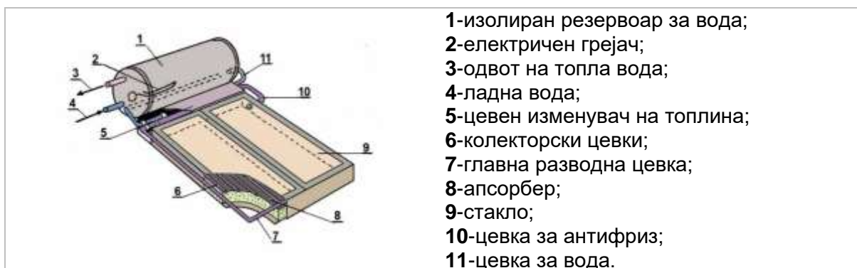
Сл.31. Индиректна сончева постројка за санитарна топла вода -термосифонски со вертикално поставен резервоар (изменувач на топлина)
