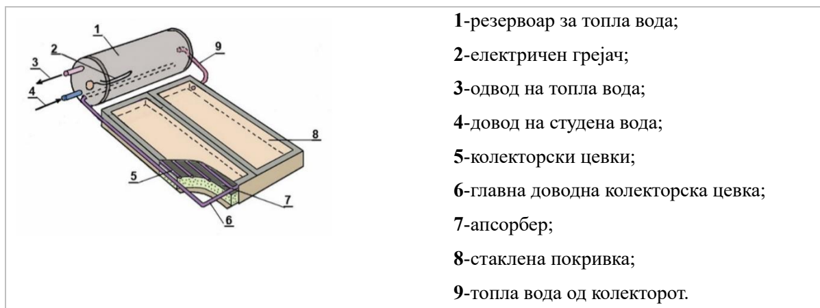
Сл.1. Директен термосифонски сончев систем за загревање на вода без циркулациона пумпа
