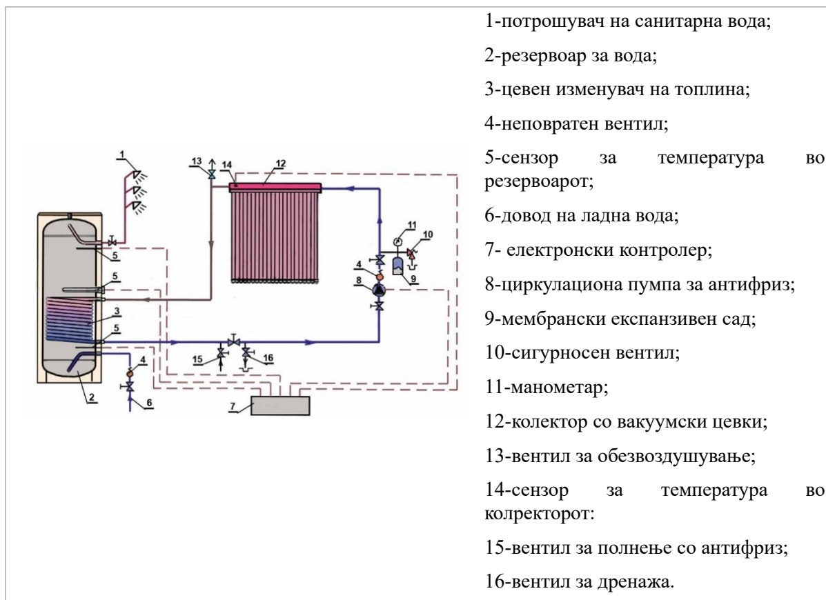
Сл.6. Индиректен сончев систем за загревање вода за санитарни потреби со принудна циркулација и со колектор со вакуумирани цевки
