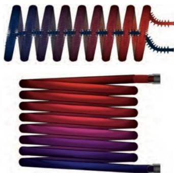
Сл.28.. Разменуваач на топлина со мазни цевки. Доле: Обичен цевен разменуваач на топлина
